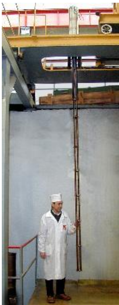
Рис.2. 24-х точечный сигнализатор уровня теплоносителя ядерного реактора
